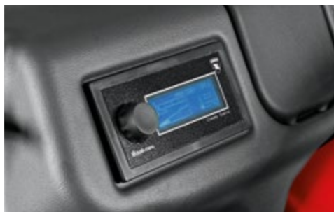
Lo strumento digitale a cristalli liquidi AirControl registra costantemente i parametri di pressurizzazione in cabina segnalando i valori di pressione interna e le ore di utilizzo dei filtri a carboni attivi Cat. 4 .
