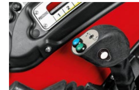
IMPUGNATURA CON PULSANTI ELETTRICI Comandi per l'attivazione proporzionale dei distributori.
