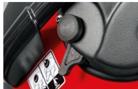
FLM (Fast, Lift, Management) Comando di alzata rapida e di discesa proporzionale del sollevamento.
