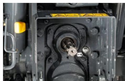
PRESA DI FORZA Albero PTO con due range di utilizzo, 540/540E e standard.
