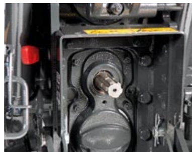
PRESA DI FORZA • Cambio con PTO post. 540/1000 giri/min • Cambio con PTO post. 540/540S giri/min
