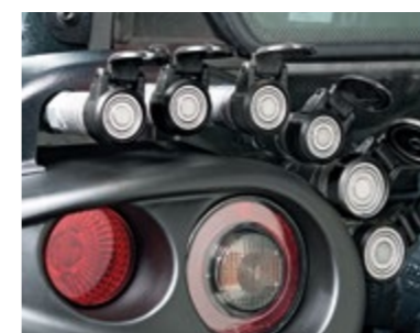
INNESTI RAPIDI POSTERIORI A FACCIA PIANA Facilità di innesto; nessun versamento di olio e maggior pulizia.
