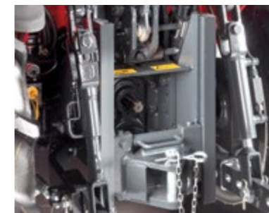
GANCIO SLIDER Integrato nel sollevamento posteriore, offre all'operatore varie posizioni per un pratico allestimento del trattore e rapido allineamento delle attrezzature trainate.
