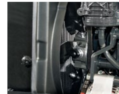
ACS (Automatic Clean System) Ventola motore con inversione del flusso. Riduce la necessità di pulizia delle griglie frontali, rendendo più costante il raffreddamento del propulsore.
