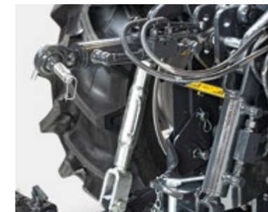
TIRANTE VERTICALE E TERZO PUNTO IDRAULICO Ottimizza il posizionamento e l'inclinazione delle attrezzature.
