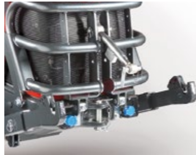
SOLLEVATORE ANTERIORE In combinazione con il bullbar e 1 distributore a doppio effetto permette l'utilizzo di tutte le attrezzature frontali.
