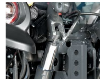
SOSPENSIONE IDRAULICA Sospensione idraulica sul sollevatore posteriore UNIFLEX.
