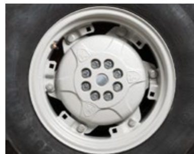
FLANGE IN GHISA POSTERIORI Flange in ghisa che incrementano il peso posteriore del trattore.
