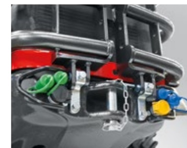
INNESTI RAPIDI ANTERIORI Sollevamento anteriore > 6 innesti replicati da posteriore di cui 2 doppi effetti + 1 mandata continua regolabile elettronicamente e 1 semplice effetto.
