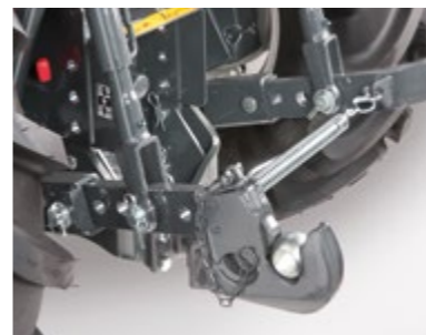
BARRE REGISTRABILI Attacco a 3 punti posteriore con barre registrabili ed agganci rapidi.
