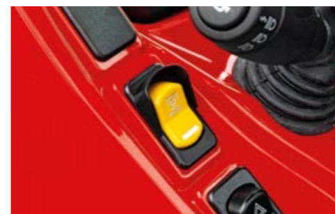
COMANDO PER IL MANTENIMENTO DELLA PRESA DI FORZA Comando che mantiene attiva la PTO anche in assenza dell'operatore a bordo del mezzo.
